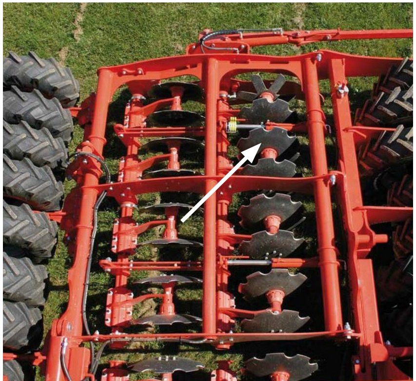
Малюнок 1. Компактна дискова борона причіпної універсальної сівалки KUHN ESPRO 6000 R.
