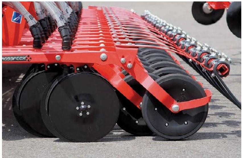
Малюнок 2. Сошникова балка із 40 дводисковими сошниками, прикочувальними колесами та бороною для покриття.
